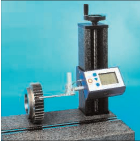
Bild: Oberflächenmessgerät Surftronic 25 mit höhenverstellbarem Stativ
