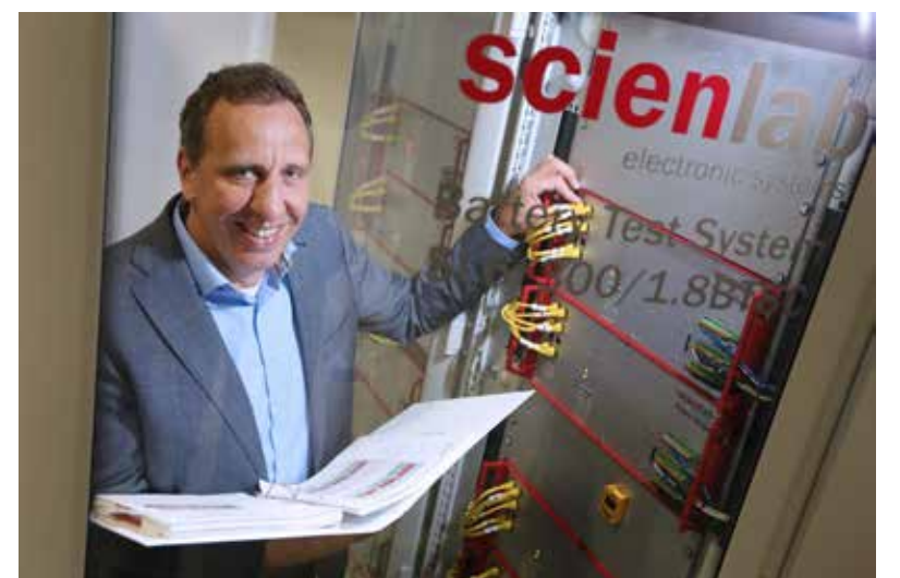
Dr. Michael Schugt vor einem Testsystem. Der Technik-Schrank bildet das komplette Fahrzeug elektronisch nach Quelle: Lutz Leitmann/Stadt Bochum, Presseamt
